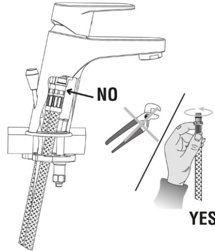
L'attacco flessibile con raccordino maschio filettato con OR da avvitare al rubinetto monocomando miscelatore, monoforo ecc., dalla parte del rubinetto, deve essere **AVVITATO A MANO E NON CON CHIAVI OD ALTRO**, onde evitare incrinature o cricature da forzatura che, con il tempo e colpi d'ariete, possono dare origine alla rottura del raccordino stesso con conseguenti gravi danni all'appartamento, imputabili solo alla scorretta installazione.
